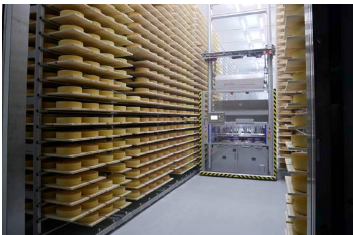
Die Käselaiibe werden im Reifelager in Steingaden vollautomatisch geschmiert und gewendet. Rechts: In den eigenen Filialen und den Franchisegeschäften wird das Winweb-Ladensystem genutzt.
